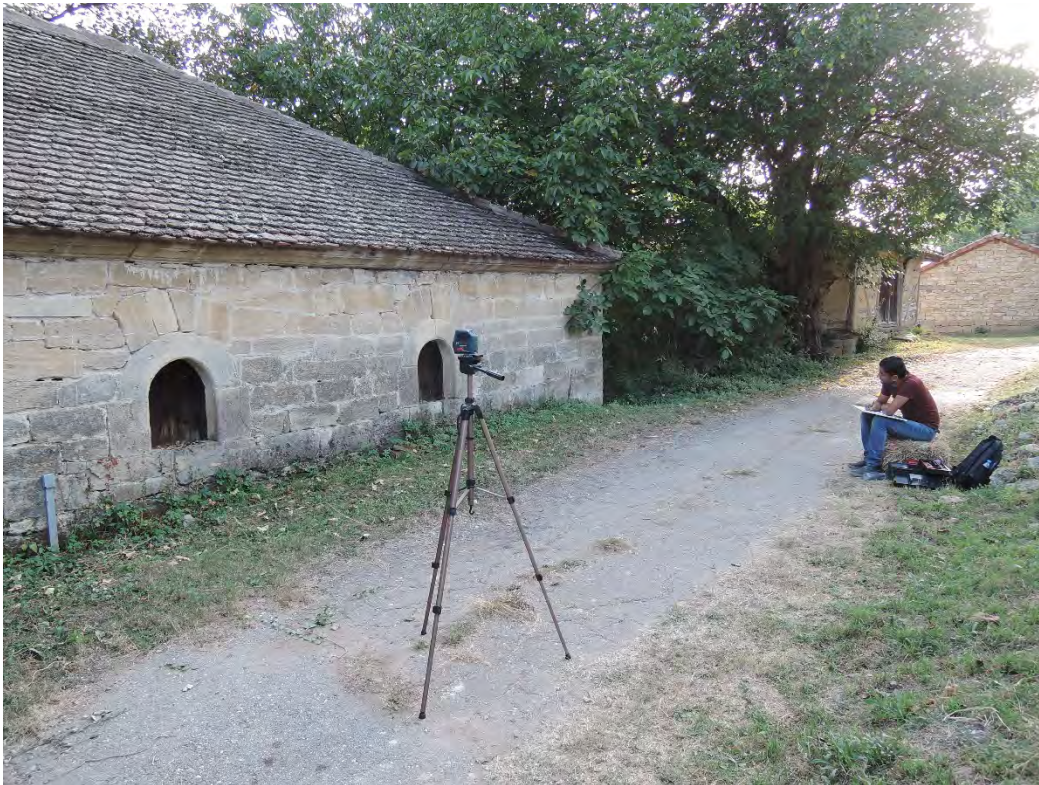
Снимање пивнице Драгутина Жикића: скицирање објекта, мерење нивелета, мерење детаља објекта и исцртавање
